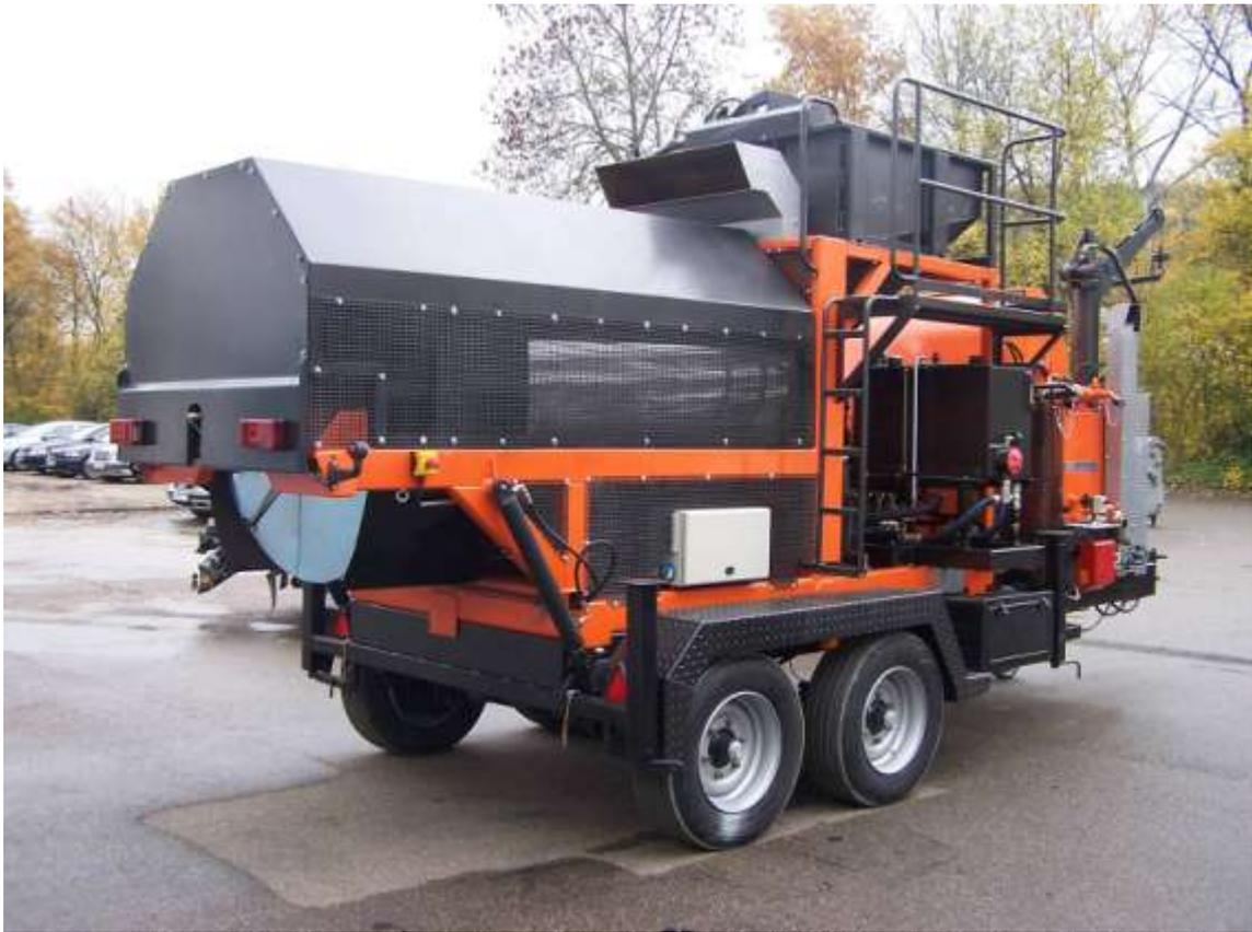
MAQUINA FABRICANTE DE AGLOMERADO ASFÁLTICO
