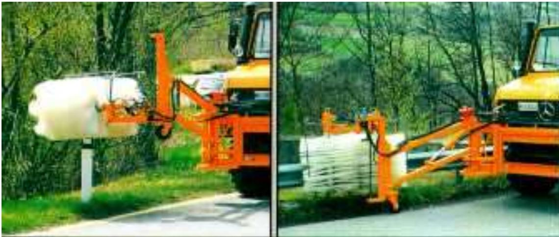
EQUIPO DE LIMPIEZA DE HITOS Y BARRERA BIONDA
