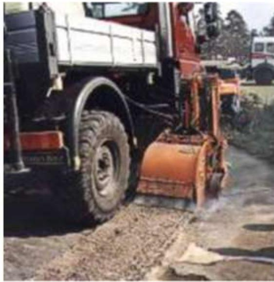
FRESADORA LATERAL SOBRE CAMIÓN UNIMOG
