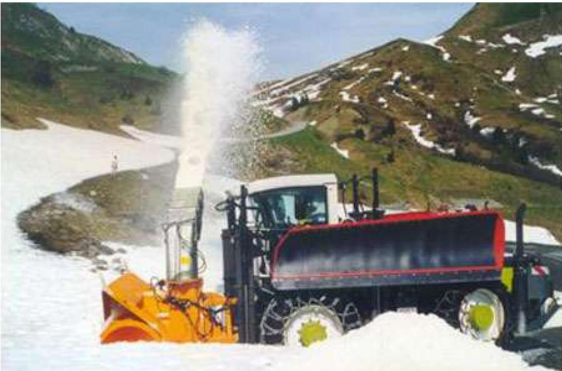
FRESADORA Y HOJA LATERAL EN CLAAS XERION
