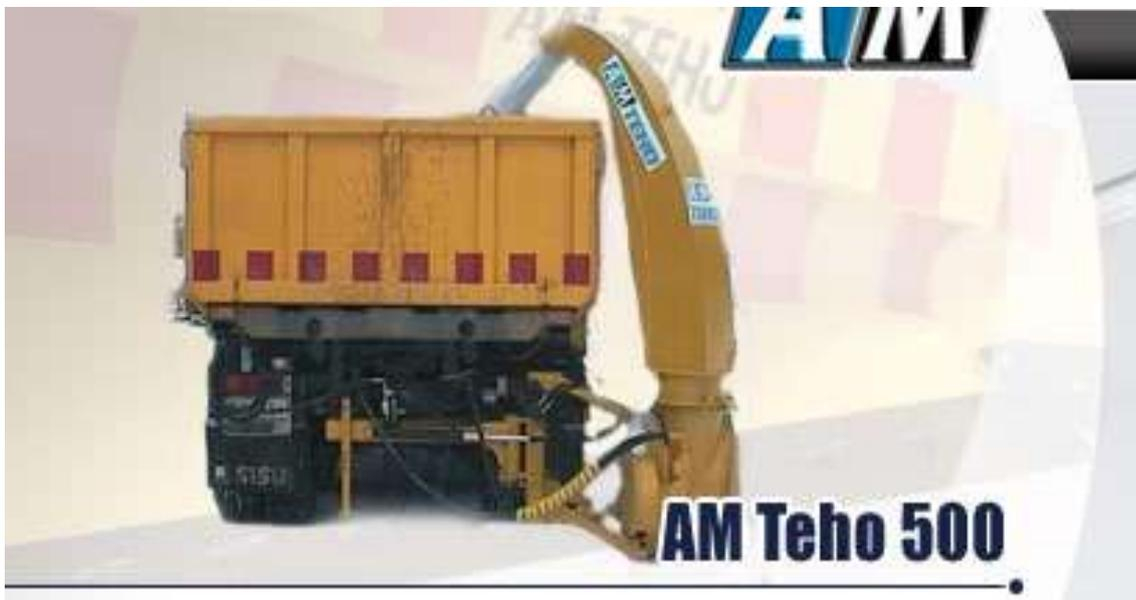
FRESADORA AUTO-CARGANTE EN TRASERA DE CAMIÓN
