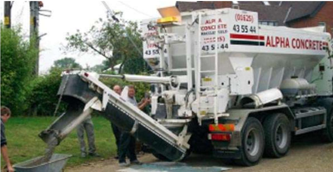
CAMIÓN FABRICANTE DE HORMIGÓN "IN SITU"
