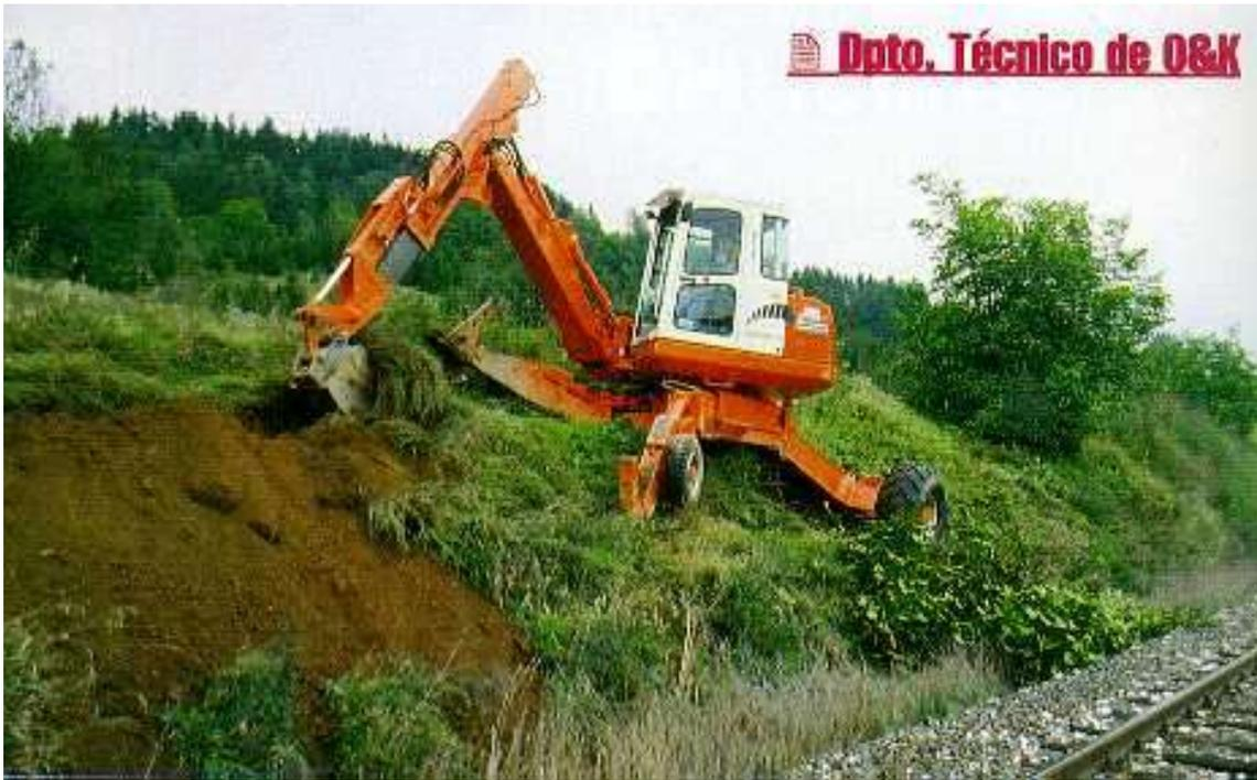
RETROEXCAVADORA GIRATORIA TIPO "PATAS DE ARAÑA"
