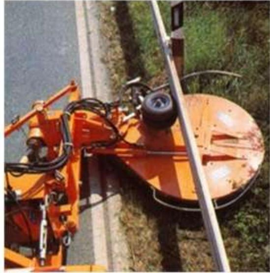
DETALLE DE EQUIPO DESBROZADOR BAJO BIONDAS
