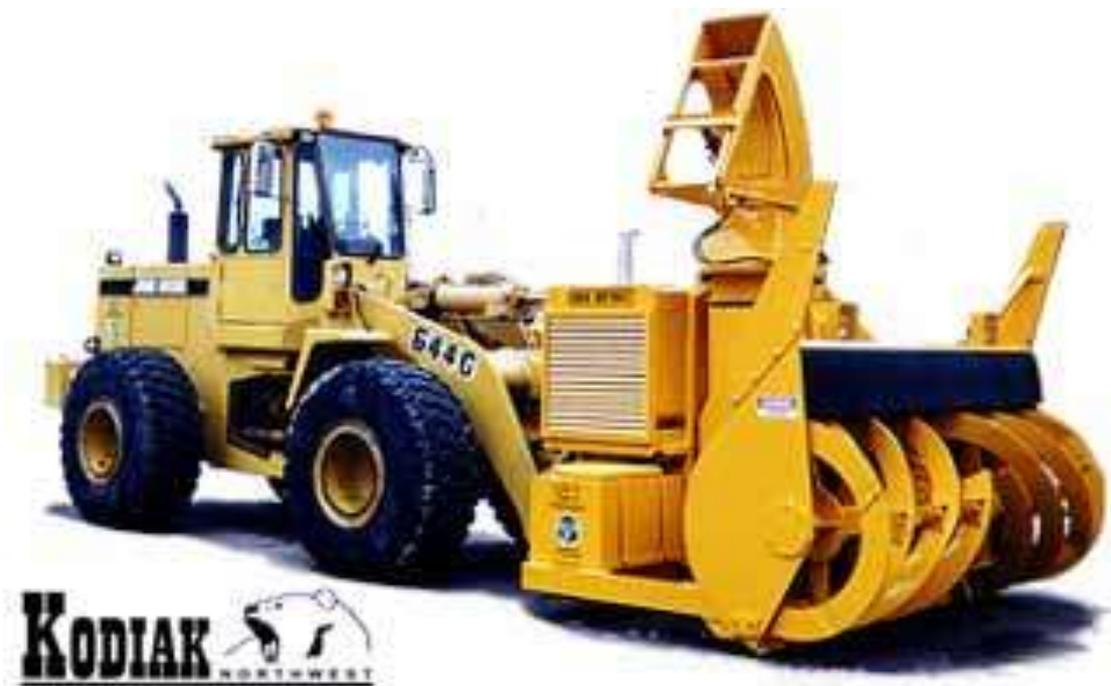
ACOPLE DE FRESADORA CON MOTOR INDEPENDIENTE SOBRE CARGADORA
