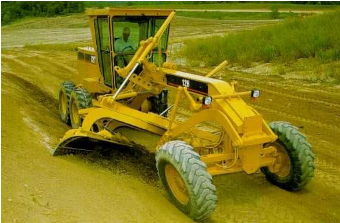
MOTONIVELADORA EN REPERFILADO DE TALUDES
