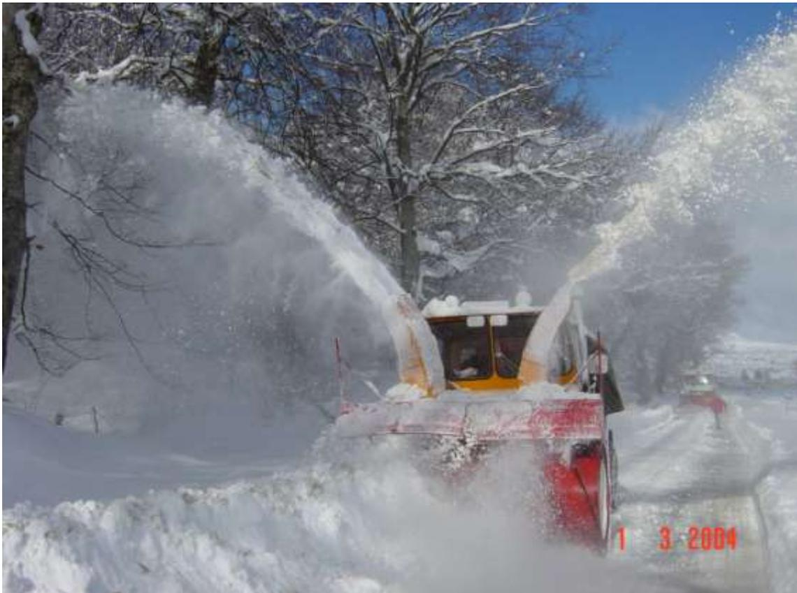
FRESADORA FRONTAL CON MOTOR AUXILIAR
