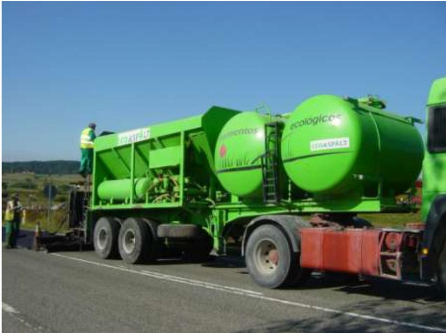
MÁQUINA DE EXTENDIDO EN SEMI-REMOLQUE.
