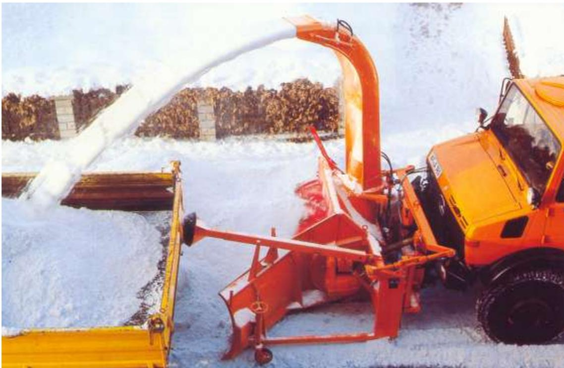
HOJA-FRESA CARGANDO NIEVE RETIRADA SOBRE CAMIÓN
