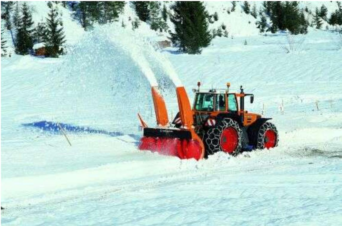
FRESADORA TRASERA ACCIONADA POR TRACTOR
