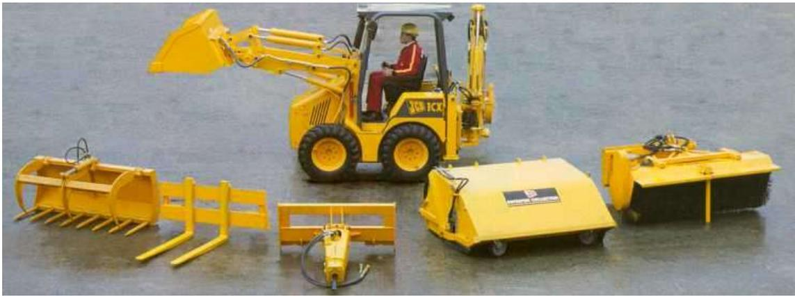
MINI EXCAVADORA-CARGADORA CON IMPLEMENTOS JCB1CX
