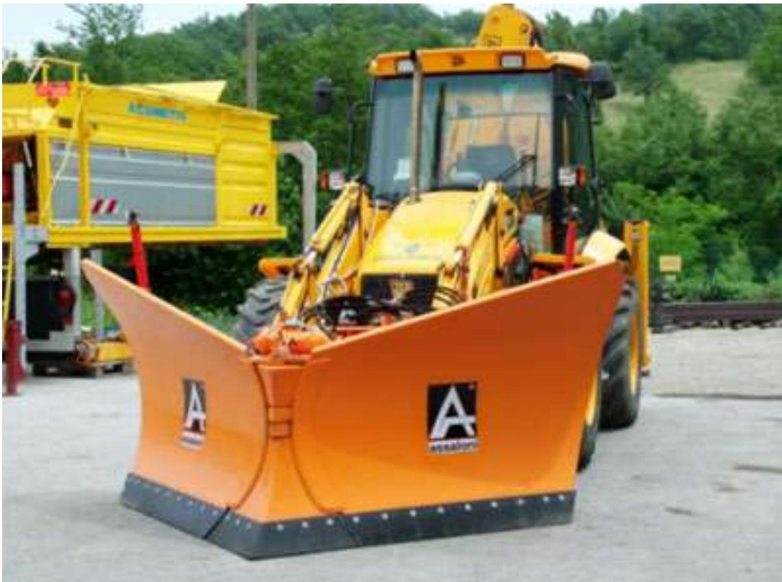
CUÑA COLOCADA SOBRE MÁQUINA MIXTA
