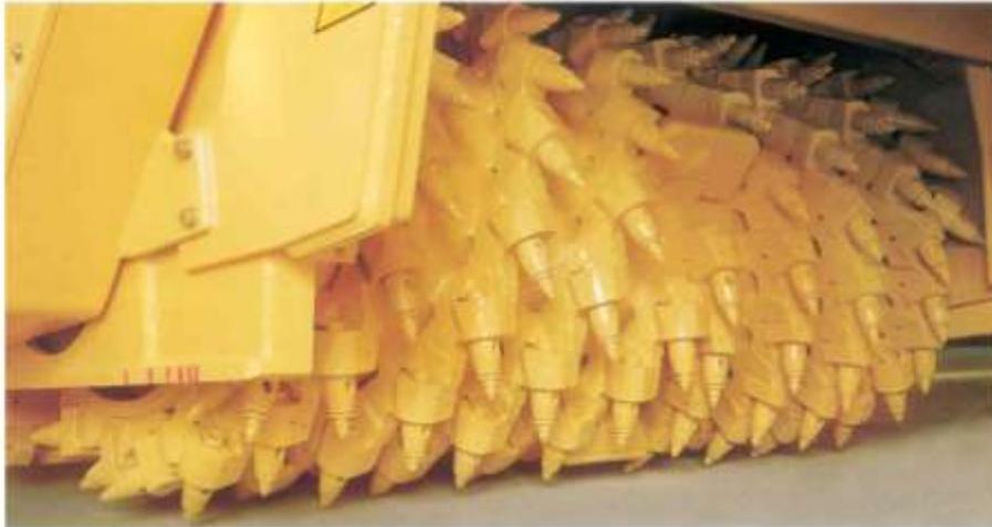
Tambor portaútiles de rápida extracción de tipo cónico con características de gran penetración y bajísimo desgaste. Extracción extremadamente rápida y fijación segura y eficaz gracias a las características del cono.
