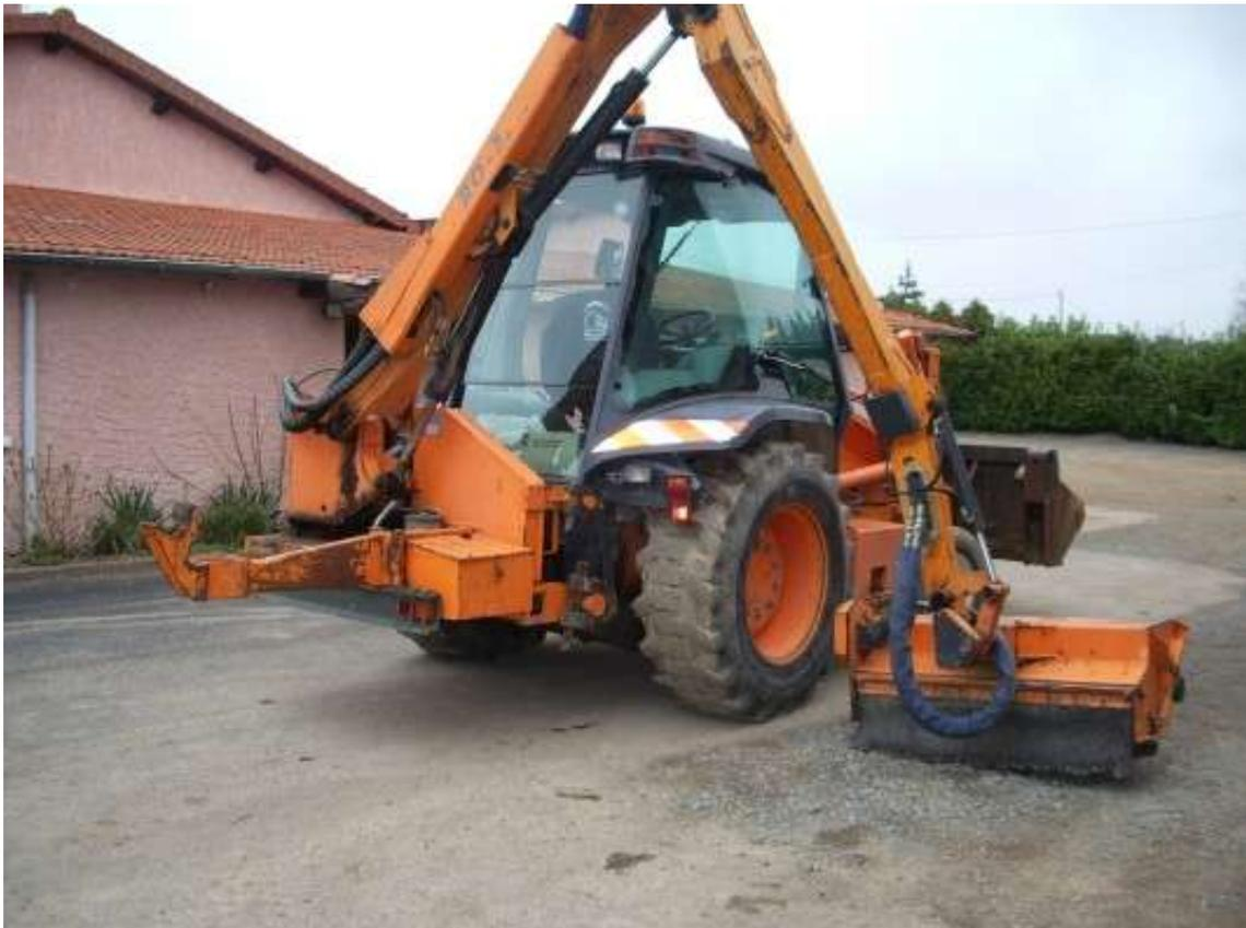
DESBROZADORA SUSTITUYENDO AL BRAZO RETRO EN MÁQUINA MIXTA
