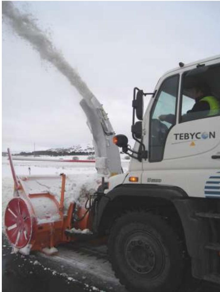
**TURBO-FRESADORA DINÁMICA SOBRE UNIMOG**
