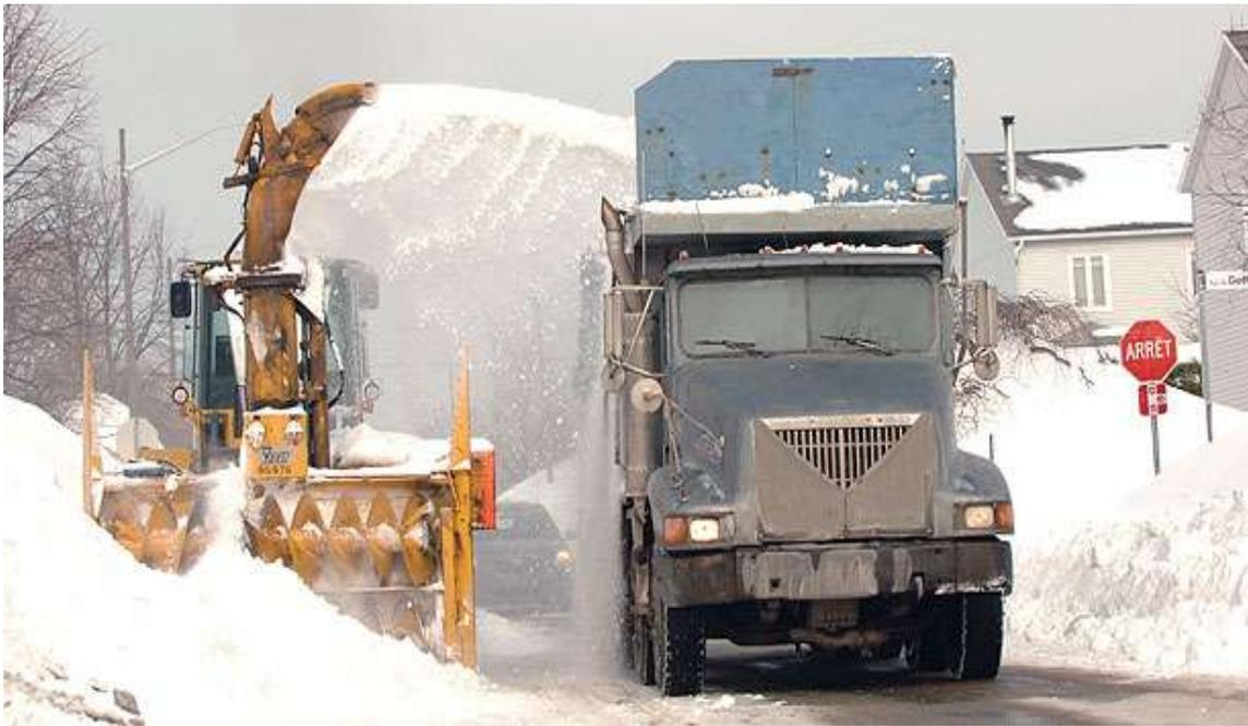
FRESADORA FRONTAL CARGANDO NIEVE SOBRE CAMIÓN
