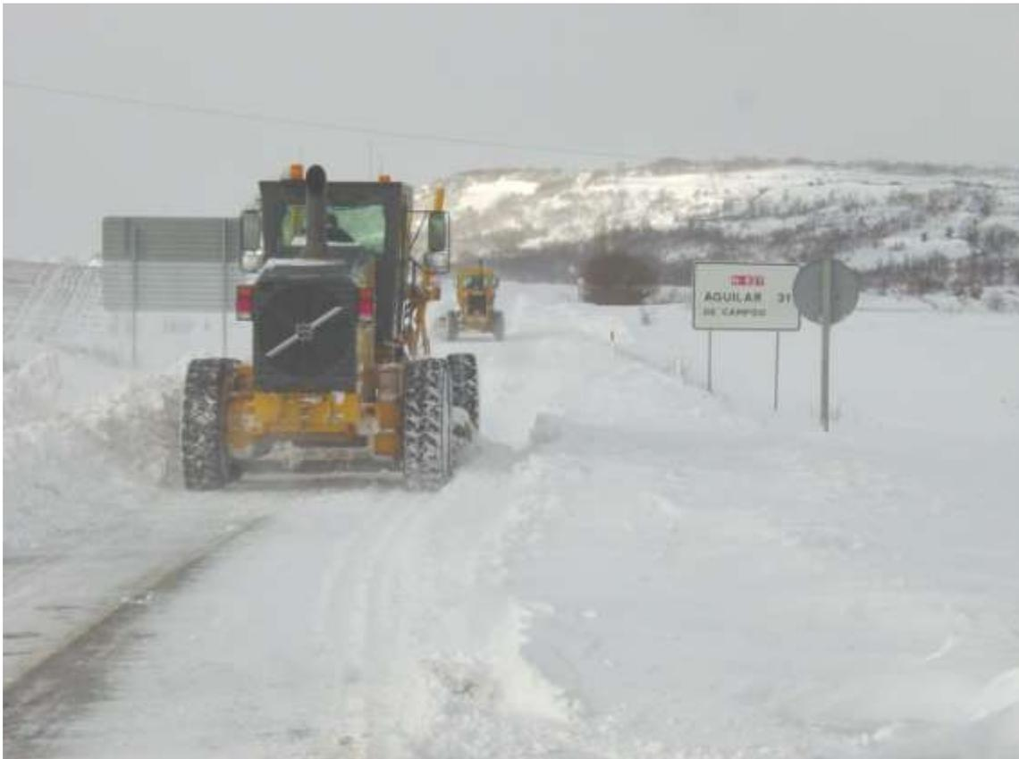
MOTONIVELADORA RETIRANDO NIEVE DE CALZADA
