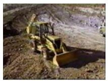
Si necesita mas fuerza hidráulica al acercarse al camión deprima el botón de neutral que esta en la palanca del control del cucharón esto neutralizara la transmisión y proporcionara mayor velocidad para levantar los brazos del cargador.
