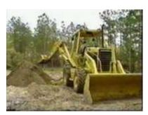
Es muy importante saber que la fuerza de excavación y de levantamiento continúan siendo las mismas con altas y bajas revoluciones, solo la velocidad de los implementases disminuyen a RPM mas bajas.
