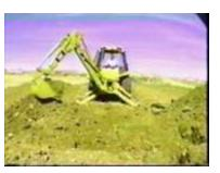
Cuanto más profunda la zanja más ancha debe ser la parte superior de ésta, una vez que ha alcanzado la profundidad deseada, necesitará mover la máquina para seguir excavando, la va a mover con los controles de la pluma y del brazo, posicione el cucharón en la zanja donde hizo el último corte, pero no se aleje tanto que no pueda alcanzar su trabajo, levante ligeramente del suelo el cucharón del cargador, esto evitara que penetre en el suelo al mover la máquina, tire lentamente de ambas palancas.
