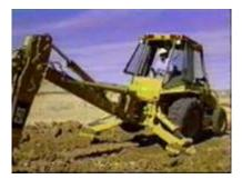
Una vez que alcance la posición correcta de excavación, suelte las palancas y baje la máquina nuevamente sobre los estabilizadores.
