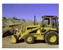
En las tareas difíciles de excavación tal vez desee plegar el lampón para estabilizar mejor el extremo delantero, para girar el asiento tire de la palanca todo hacia atrás y empuje el asiento totalmente hacia atrás, ahora empuje la palanca y gire el asiento hasta dar frente al extremo posterior, ajuste el asiento hasta que se sienta cómodo.
